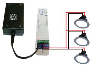
CONNECTING THE INCORRECT POWER SUPPLY TO THE LIGHT CONTROLLER WILL DAMAGE THE UNIT AND VOID THE WARRANTY
